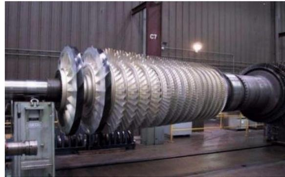
Figure 2. CCGT Shaft Blades<sup>6</sup>
