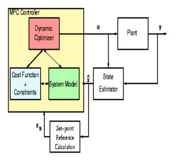
Fig: Basic MPC Loop
